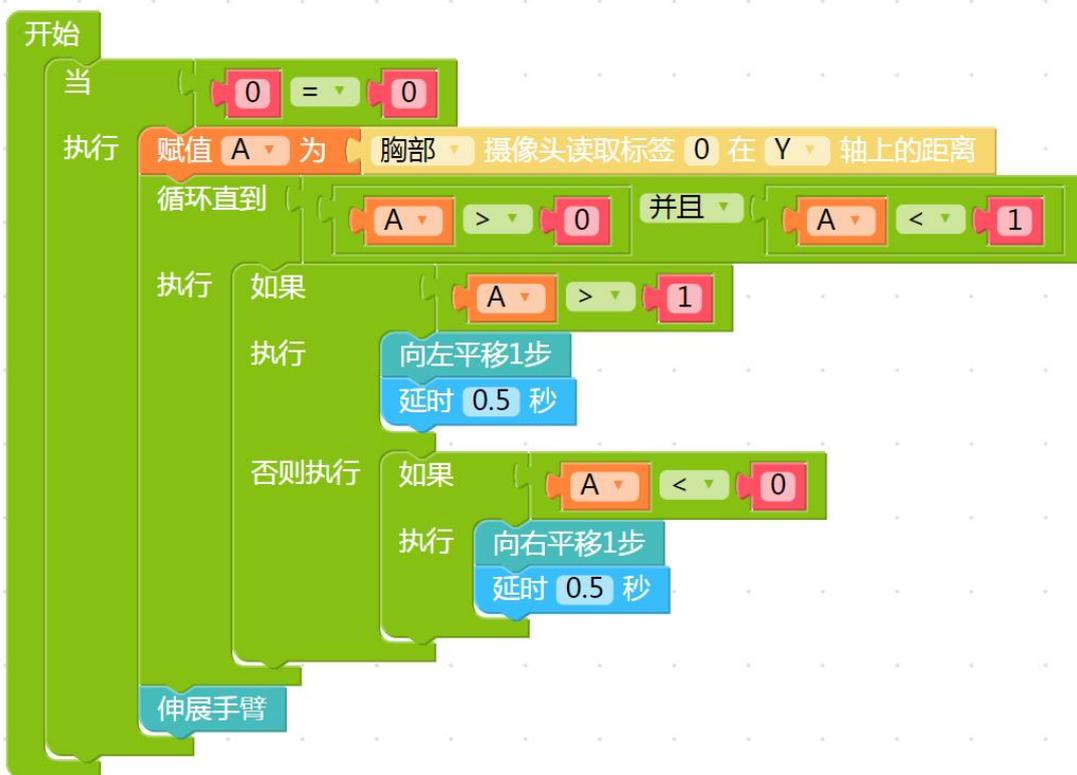
▪ 案例说明：“当 0=0”指令是为了使机器人对齐 ARtag 的程序一直执行。A 为自定义变量用于读取 ARtag 于机器人的 Y 轴上的距离（机器人右侧为 Y 轴正方向），当机器人距离 ARtag 距离大于正方向上 1 米时，机器人将向左平移一步，当机器人距离 ARtag 距离正方向上小于 0 时，机器人将向右平移一步，直到机器人在 Y 轴方向上对齐 ARtag 时停止以上过程并执行伸展手臂动作表示已对齐。
